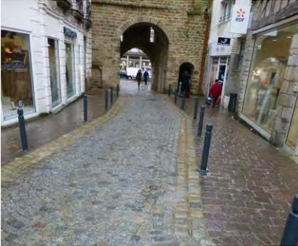
Traitement de sol composite, pavage de chaussée granit et faux trottoirs de dalles de porphyre
